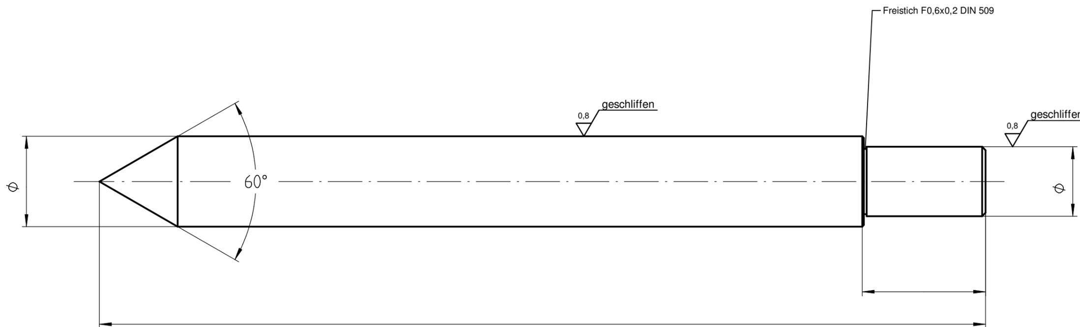
Vakuumgehärtet HRC 58 +/- 2
